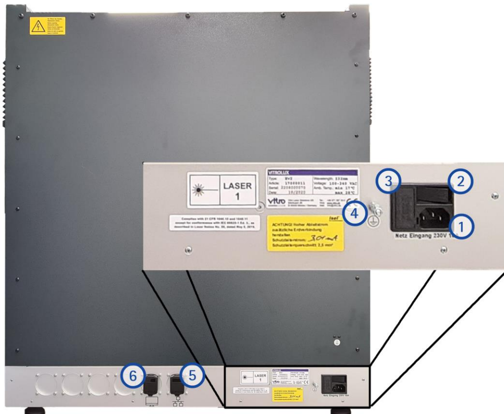
Abbildung 9: Hauptschalter und Anschlüsse auf der Rückseite
