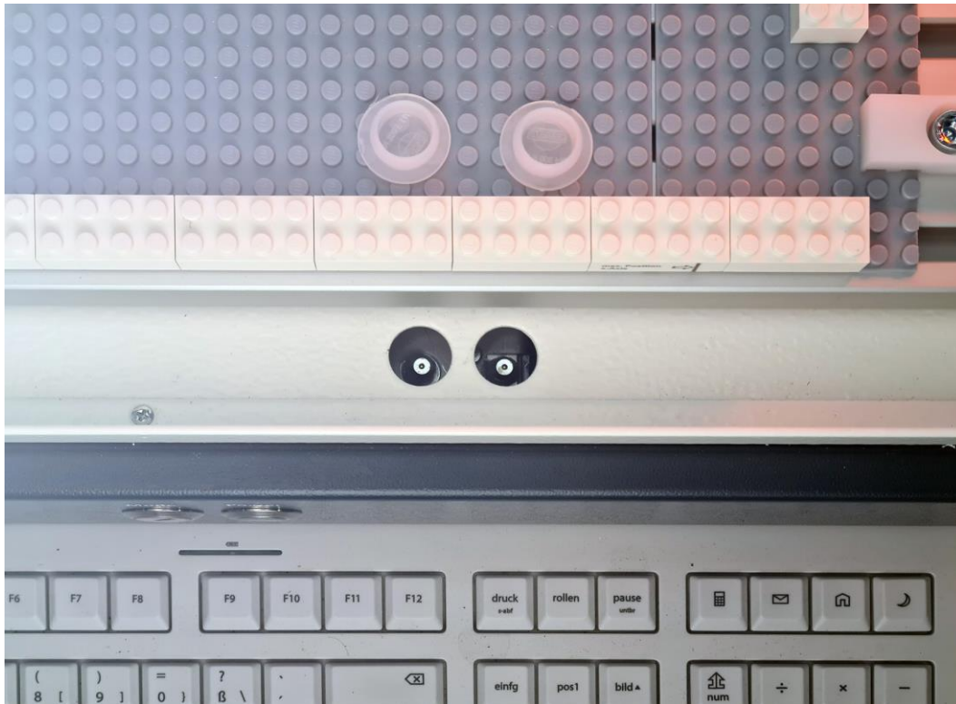
Abbildung 20: Zugang Schmierung Y-Achse
