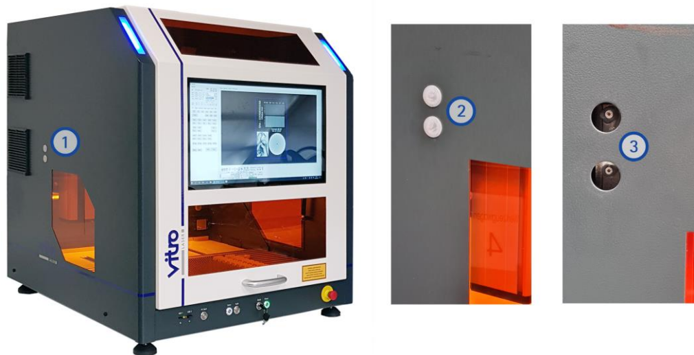
Abbildung 19: Zugang Schmierung X-Achse
